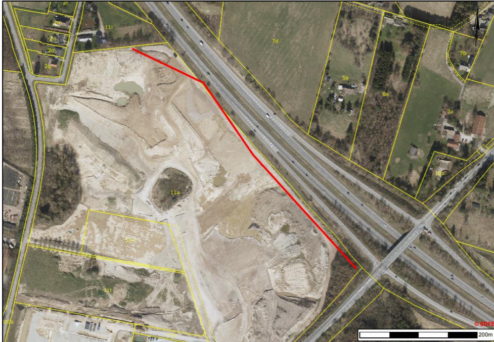
Figur 2. Luftfoto 2019. Den røde linje markerer den rørlagte strækning af det private vandløb Bøgeholmøbjet, der omlægges. På det vedlagte bilag Tegning, Farremosen 26-06-2018 udarbejdet af landsinspektørfirmaet Hyldegaard I/S er vandløbets nærmere placering indtegnede efter opmåling. Størvolden og afvandingsgrøfter/-dræn etableres i samme område som er vist på luftfotoet. Størvoldens placering i forhold til vandløbet fremgår af de vedlagte bilag med situationsplaner og oversigtskitser. De gule streger angiver matrikelskel. Målestok er angivet i nederste højre hjørne.
